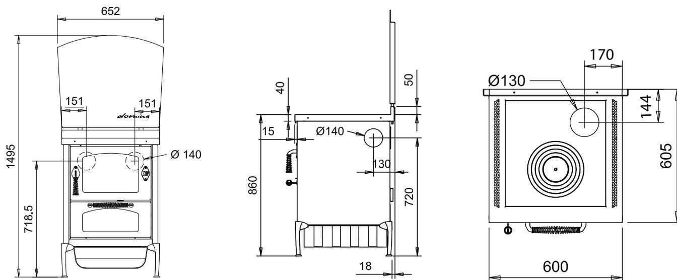
Versione con uscita fumi a destra. La versione con uscita fumi a sinistra è simmetrica.
